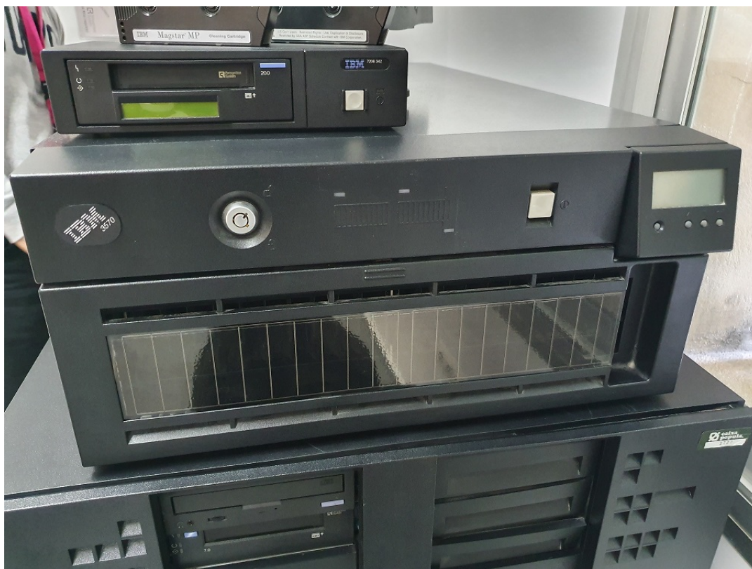
Figura 4.5: Subsistema de cinta IBM Magstar MP modelo B01 con la apertura abierta. Museo de informática
