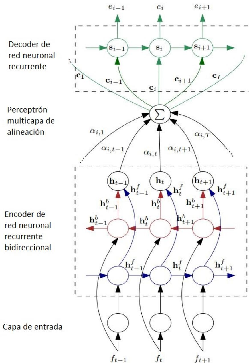
Figura 2.6: Arquitectura Encoder-Decoder con un modelo de alineación.
