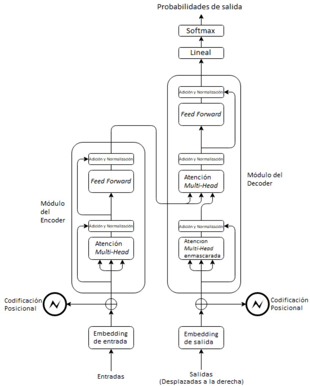
Figura 2.9: Arquitectura completa del Transformer.
