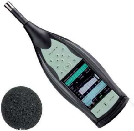
Sonómetro Bruel & Kjaer. Modelo 2250 Light y pantalla antiviento
