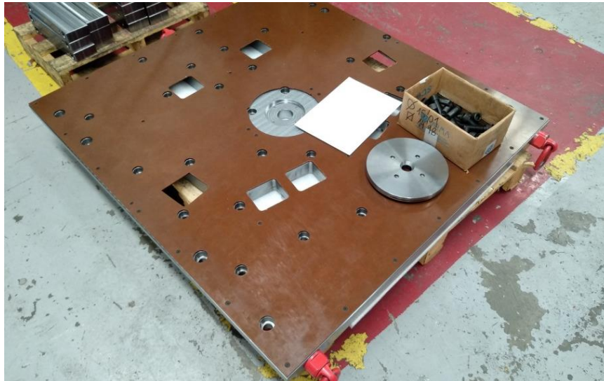
Figura 6-43. Ejemplo de placa aislante y disco centrador similares a los utilizados
