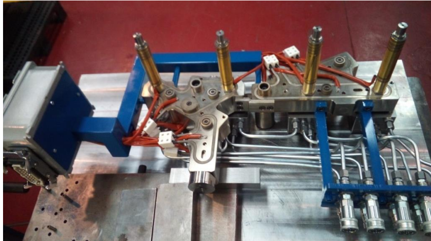
Figura 6-36. Ejemplo de cámara bimaterial con sistema de obturación hidráulico
