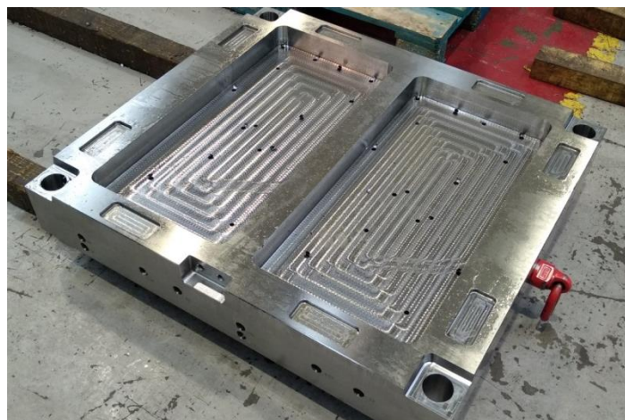
Figura 6-14. Ejemplo de placa similar a la diseñada
