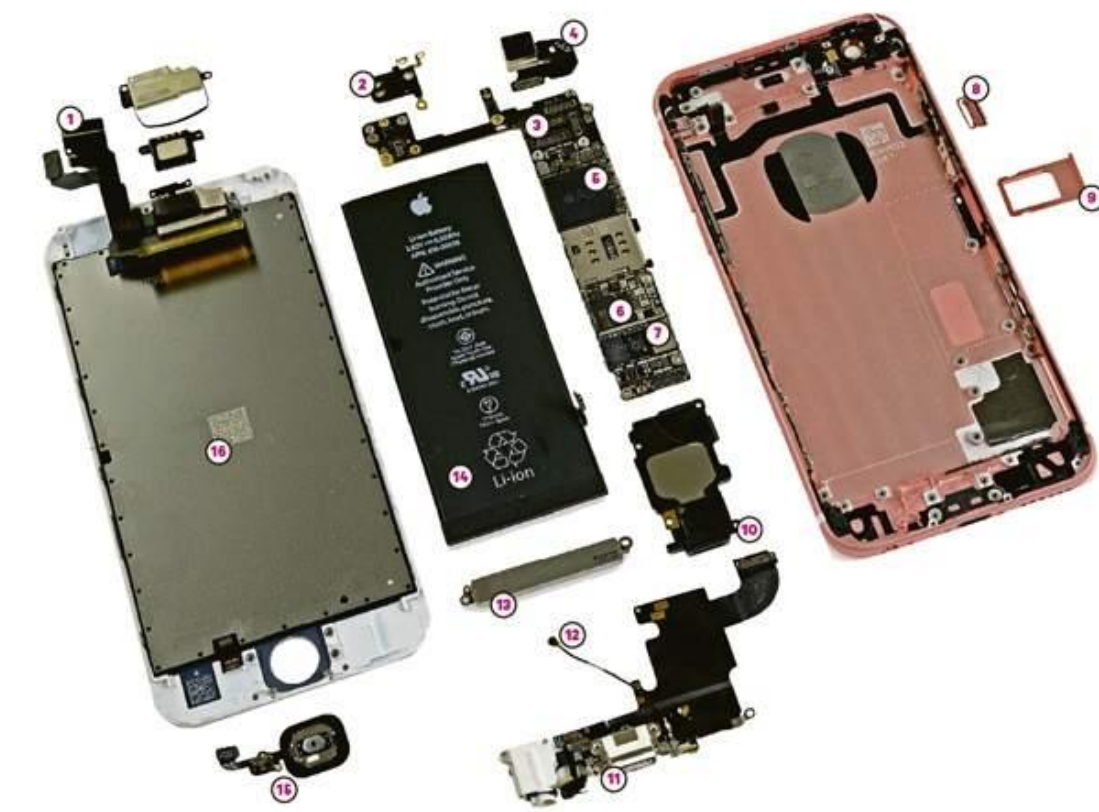
Il·lustració 13. Parts d'un telèfon intel·ligent
