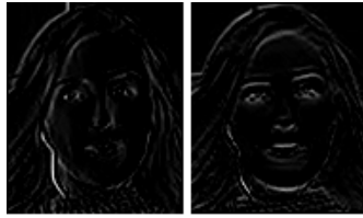
Figura 4.2: Gradientes obtenidos para el cómputo del descriptor HOG. Izquierda: gradiente horizontal. Derecha: gradiente vertical.
