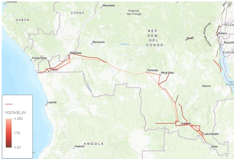
Ilustración 4 Mapa de las líneas de suministro eléctrico de la RDC Fuente: ArcGIS.com
