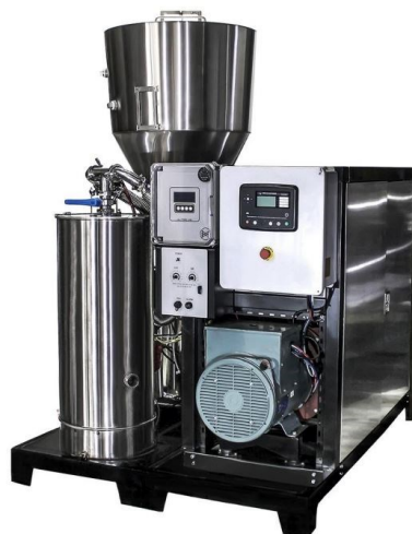
Ilustración 23 All Power Labs Power Pallet PP30 Fuente: Web del fabricante
