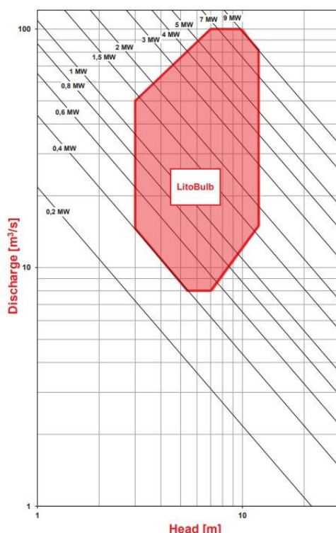
Ilustración 21 Curvas de funcionamiento de la turbina hidráulica Litostroj Power Litobulb Fuente: Ficha técnica
