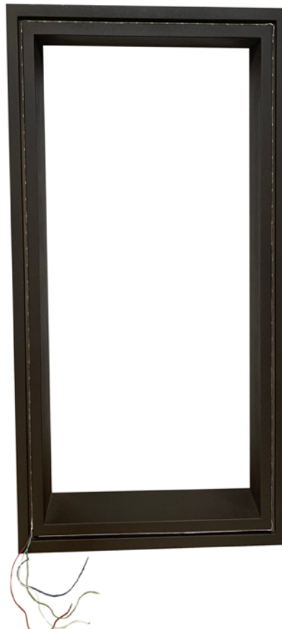
Figura 17. Tira de LEDs colocada en el marco
