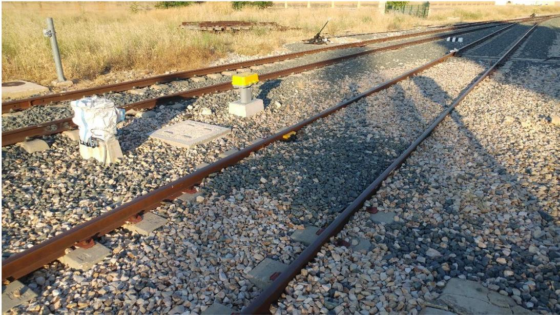
Figura 116. Pedal electromagnético contador de ejes, estación de Utiel [imagen tomada en visita a vía]
