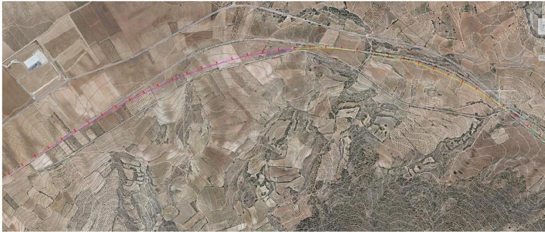
Figura 103. Curva nº4 estado alineaciones trazado modificado
