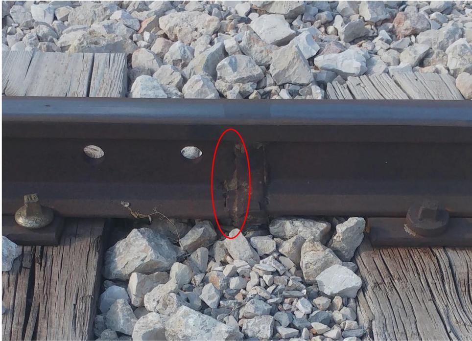
Figura 26. Defecto en soldadura [imagen tomada en visita a vía]
