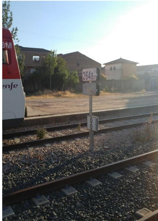
Figura 4. Señal reinicio P.K. línea 310 en estación de Utiel
