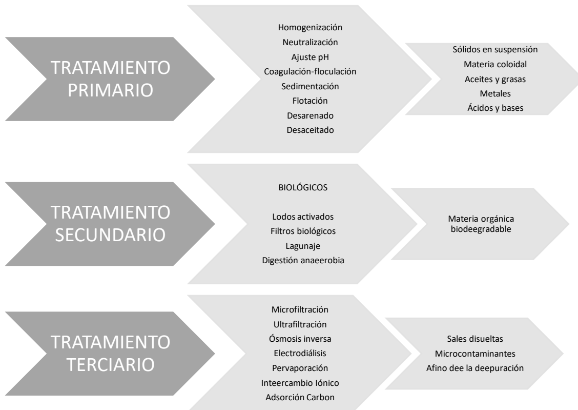
Figura 1. Principales tratamientos de las aguas residuales (Fuente: Arques et al.,2009)
