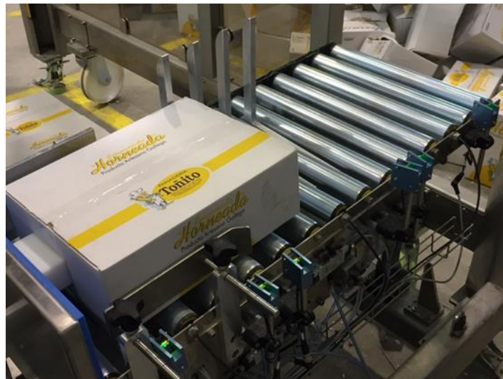
Figura 10. Detalle del centrador en la instalación.
