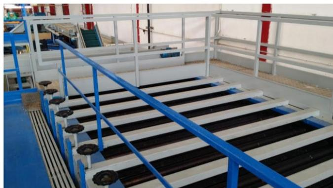
*Figura 3. Calibrador de rodillos.* <sup>[11]</sup>
