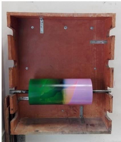
**Imagen 5.31.** Modo de almacenar correctamente el rodillo de entintado.
