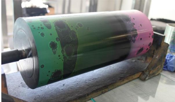
**Imagen 6.10.** Rodillo blando con micelas dañadas por efecto del tensioactivo no evaporado. Fotografía del autor.
