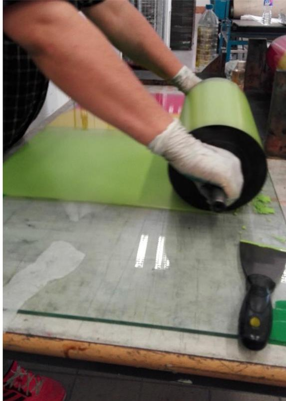
**Imagen 5.27.** El soporte temporal. Cristal de 1 cm de grosor y de dimensiones superiores al largo y ancho del rodillo. Taller de grabado. Facultad de Bellas Artes. UPV (2016). Fotografía del autor.
