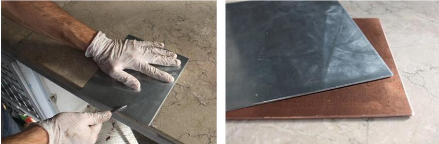
**Imágenes 6.25 y 6.26.** Bruñido del borde de la plancha (izquierda). Matrices de zinc y de cobre biseladas a 45°. Fotografías del autor.
