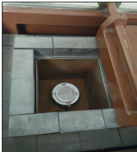
**Figura 3.1. Detector HPGe GMX-40 (ORTEC). Fuente: Elaboración propia**
