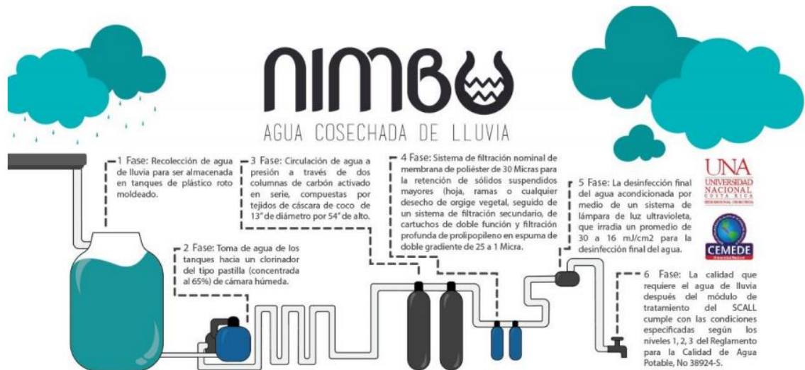
Figura 2. Proceso del SCALL para potabilización, Nicoya, Costa Rica. (Gómez, W; Rojas J; Suarez, A; Salinas, 2018)
