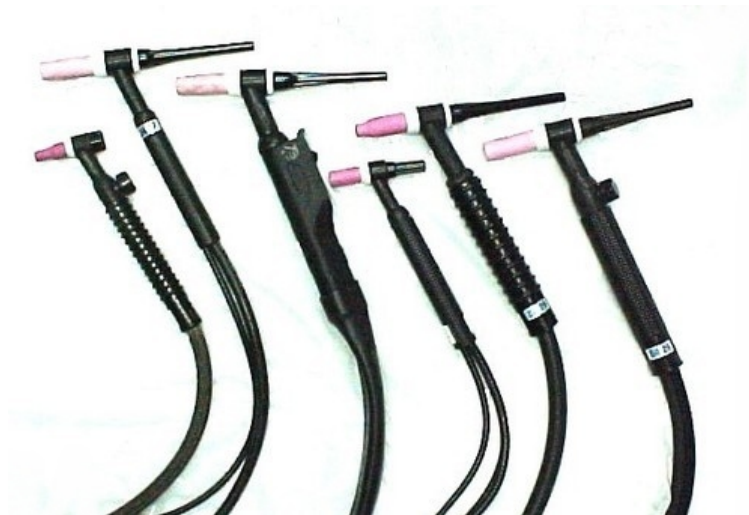
Figura 5.22: Diferentes tipos de portaelectrodos o antorchas en la soldadura TIG. [15]
