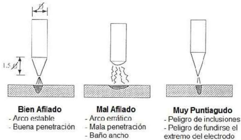
Figura 5.19: Influencia de la forma del afilado en la calidad de la soldadura. [13]
