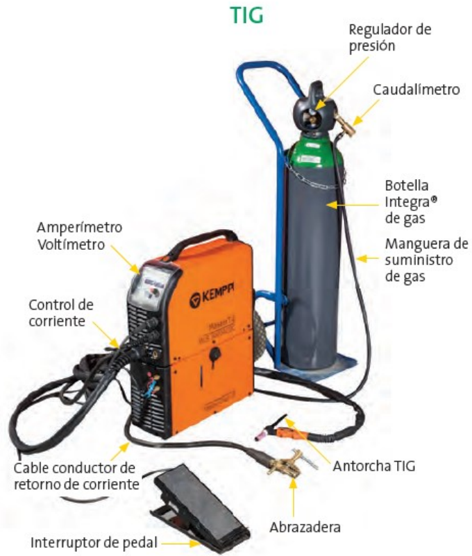
Figura 5.21: Conjunto de elementos que componen un equipo de soldadura TIG. [15]
