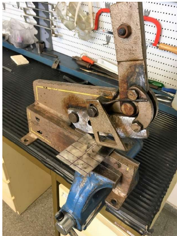
Figura 9.7: Proceso de corte de chapas para obtención de probetas.
