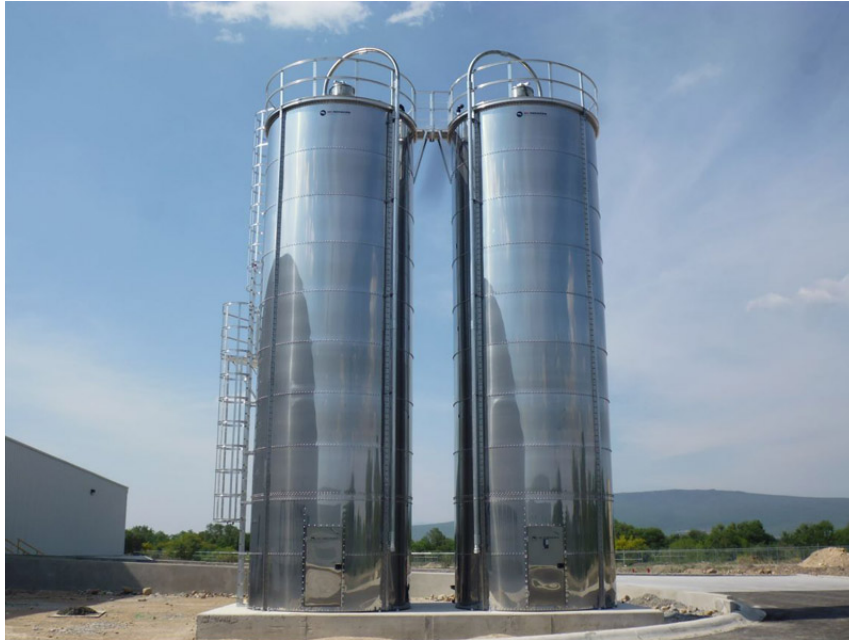
Figura 11.1: Silo de acero inoxidable con una capacidad de 120 Toneladas.
