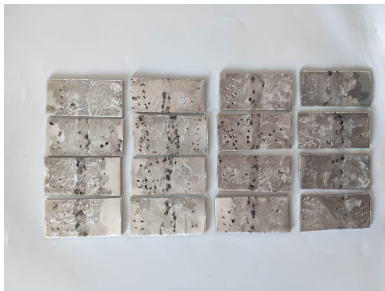
Figura 10.10: Probetas de acero inoxidable AISI 316L + ER 316L, sometidas a tracción axial y a corrosión bajo tensión en una disolución de Cloruro Férrico al 20%.
