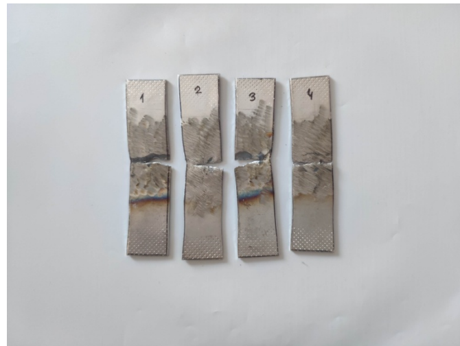
Figura 10.1: Probetas de acero inoxidable AISI 316L + ER 316L, ensayadas a tracción hasta alcanzar la rotura, para cada uno de grupos de ensayo.
