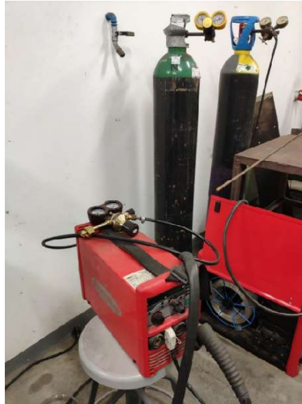
Figura 9.1: Equipo de soldadura TIG de la marca Fronius, modelo Transtig 1700.
