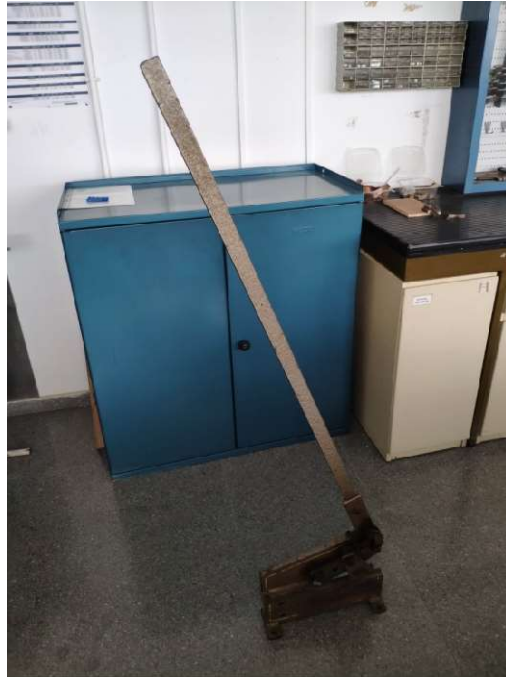
Figura 9.6: Cizalladora empleada en el corte de las probetas.
