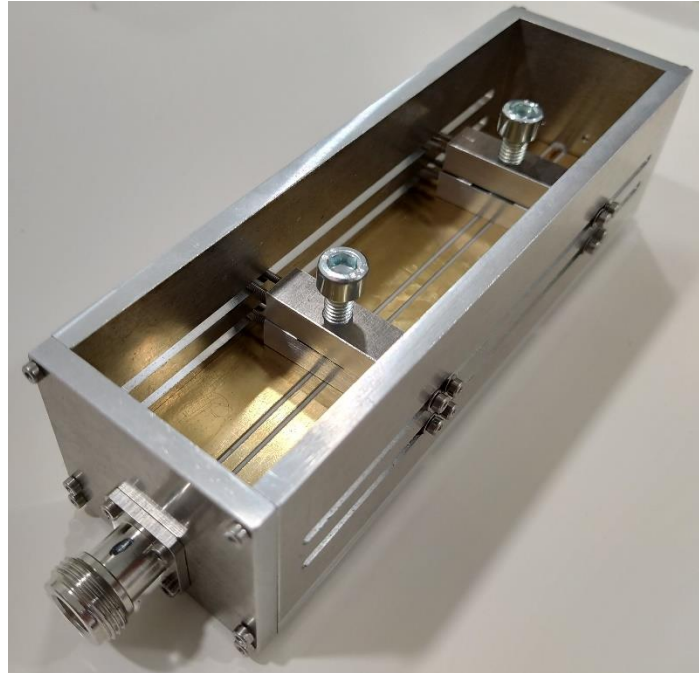
Figura. 75 Resultado final de la guía tras su mecanizado
