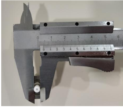
Figura. 41 Medida del diámetro del aislante del conector coaxial
