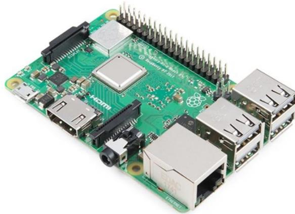
**Figura 4. Dispositivo Raspberry Pi 3B+**
