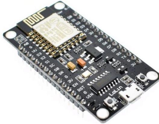
**Figura 5. Dispositivo NodeMCU V3 basado en ESP8266**
