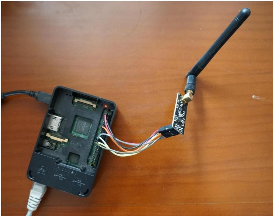
Figura 15: Raspberry Pi con módulo NRF24L01
