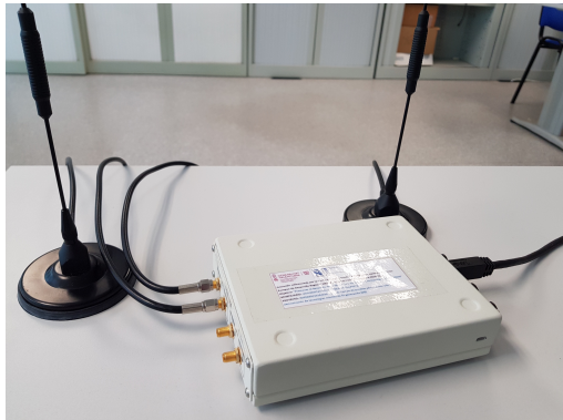
Figura 11: USRP B210 de Ettus Research y antenas de transmisión y recepción
