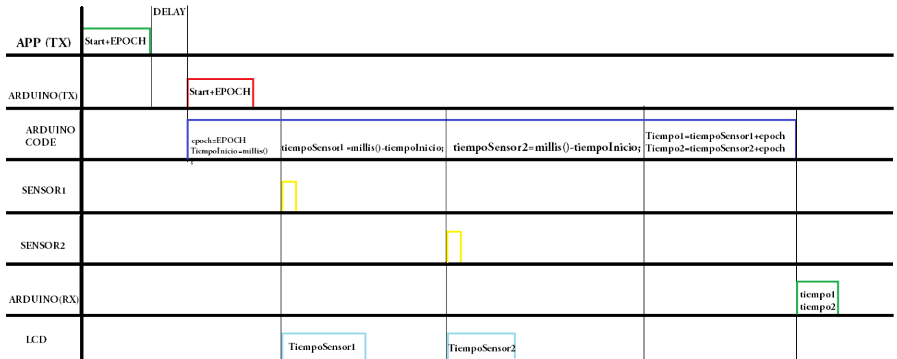
Figura 6.10: diagrama del sistema de eliminación del delay en las medidas obtenidas.
