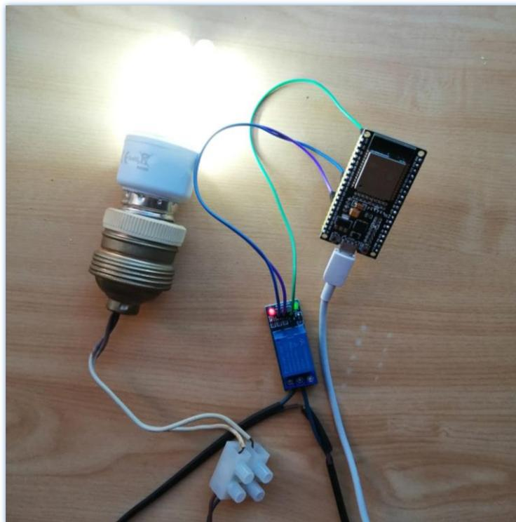
Figura 68. Montaje del circuito con el relay JQC-3FF-S-Z y el ESP32.
