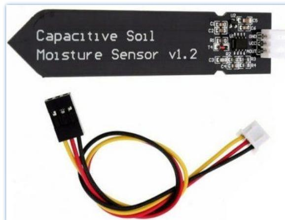
Figura 22. Sensor capacitivo de humedad.
