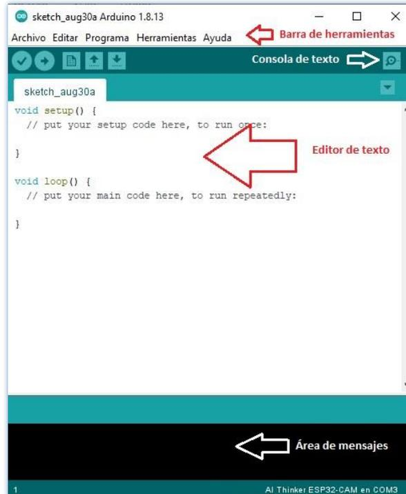
Figura 27. Secciones principales del IDE
