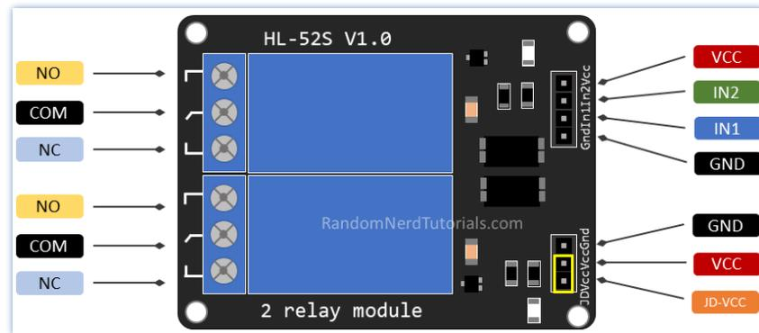
Figura 25. Pinout de Módulo Relay de 2 canales.
