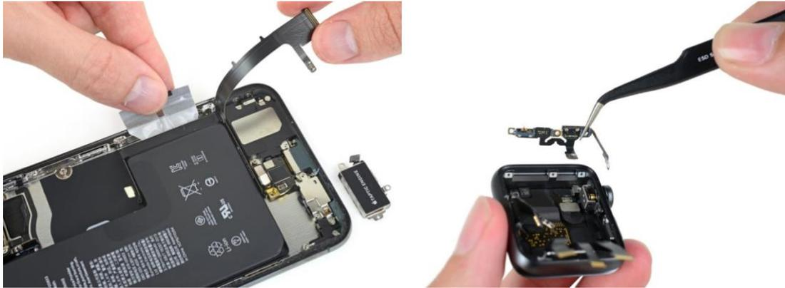
Figura 43. Posicionamiento de antenas en Iphone y Apple Watch. [25]
