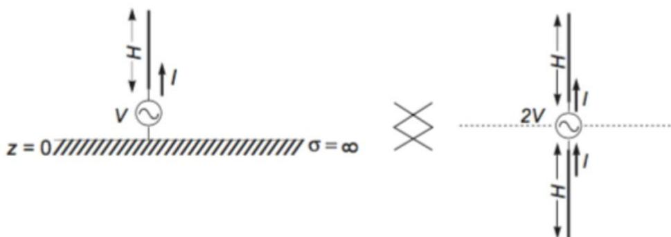
Figura 44. Equivalencia entre un Monopolo y un Dipolo aplicando teoría de imágenes [27].
