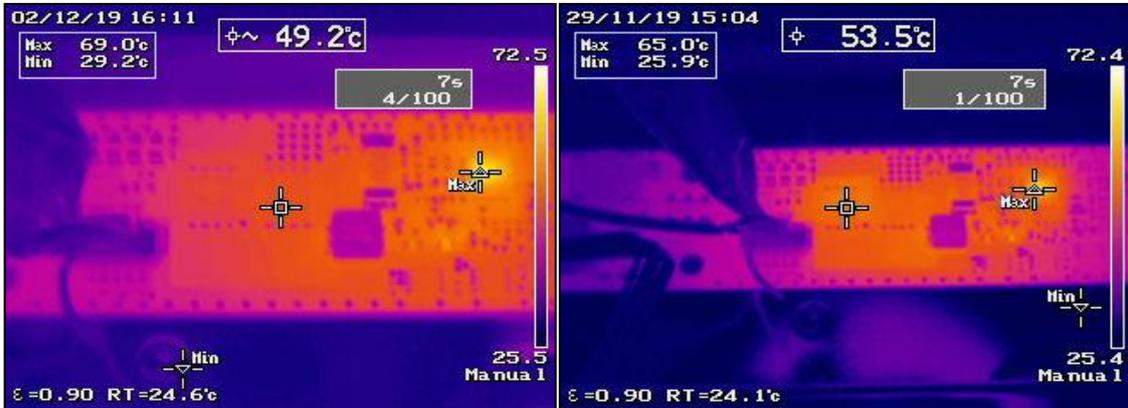
Figura 85. Análisis de temperatura en el *Buck*.
