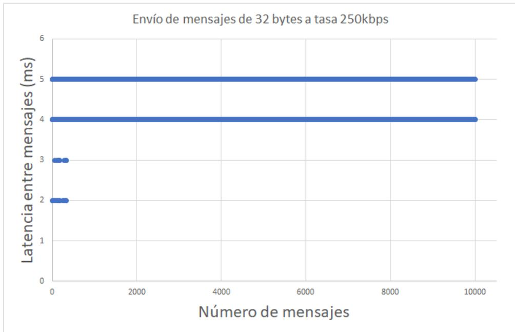
Figura 2.25: Comunicación básica Tx-Rx NRF24L01 con tasa 250 kb/s
