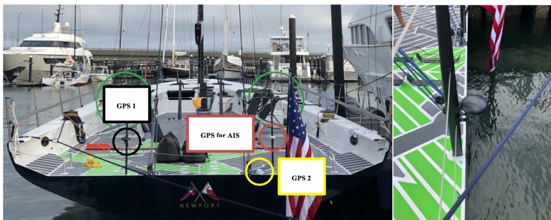
Fig. 17. Izquierda. Distribución de Antenas GPS / Derecha. Instalación antena GPS principal.
