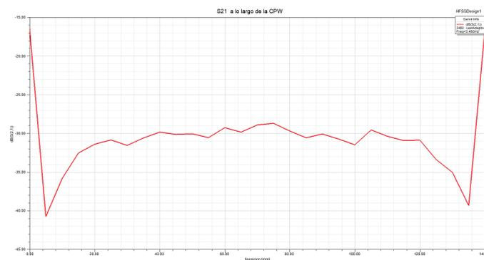
**Figura 4.46: Transmisión observada en la coplanar con la acción del cortocircuito**
