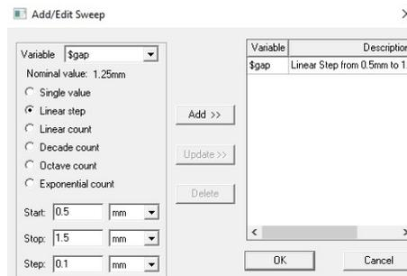
**Figura 4.19: Configuración del barrido para el gap**
