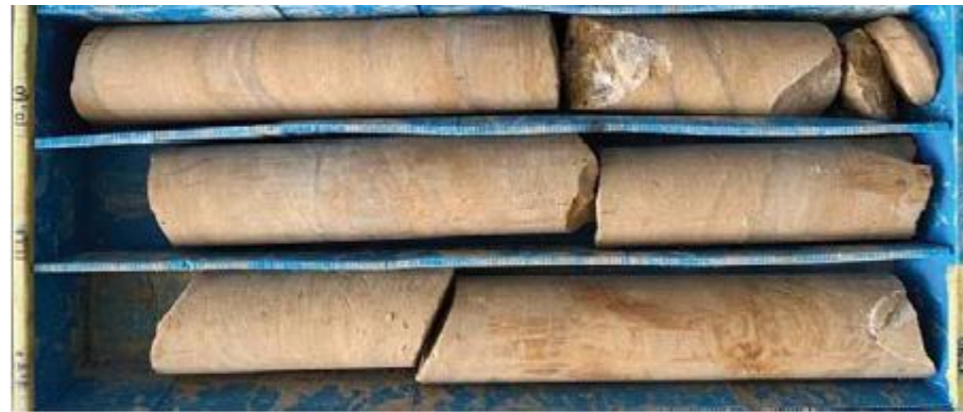
Ilustración 4.2.3. Roca caliza y margocaliza. Caja tomamuestras del sondeo S4 (Fuente: informe geotécnico).
