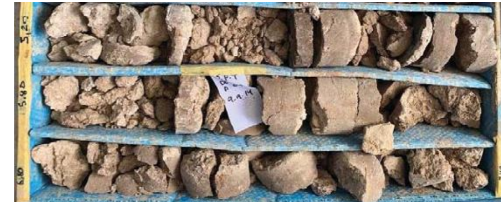
Ilustración 4.2.2. Limos arcillosos con aspecto margoso. Caja tomamuestras del sondeo S3 (Fuente: informe geotécnico).
