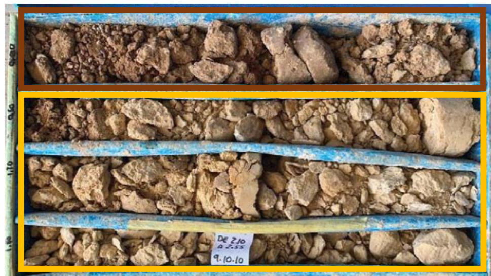
Ilustración 4.2.1. Suelo vegetal (marrón) y margas alteradas (amarillo). Caja tomamuestras del sondeo S4 (Fuente: informe geotécnico).
