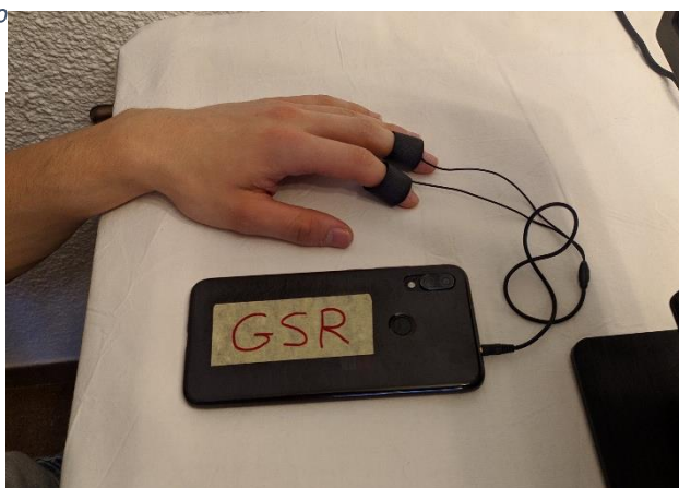
Ilustración 44: Colocación de los electrodos del GSR
