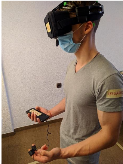
Ilustración 39: Colocación de los electrodos GSR
