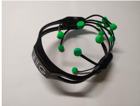
Ilustración 129: EEG final tras pintado y ensamblaje
