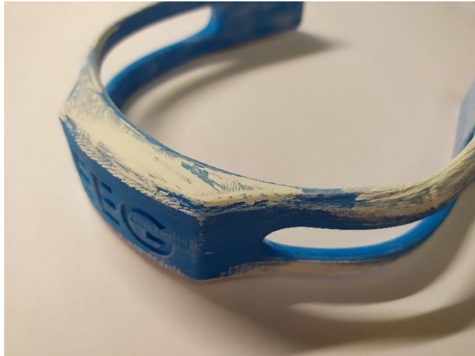
Ilustración 126: Enmasillado de la pieza impresa
