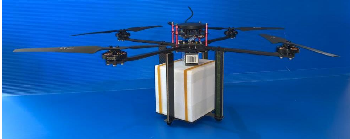
Fig. 4 – Dron con su dispositivo de liberación ensamblado / Fuente: Mapa Technology S.L
