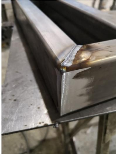
*Figura 32. Junta de soldadura acabada. Fuente: fotografía propia*
