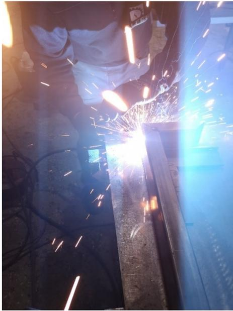
*Figura 30. Cordón de soldadura. Fuente: fotografía propia*
