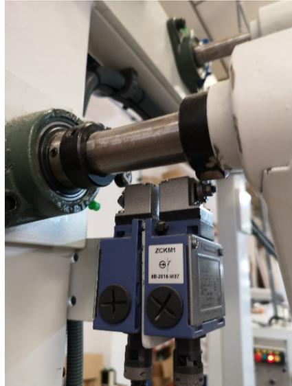
*Figura 5. Células de contacto. Fuente: fotografía propia*
