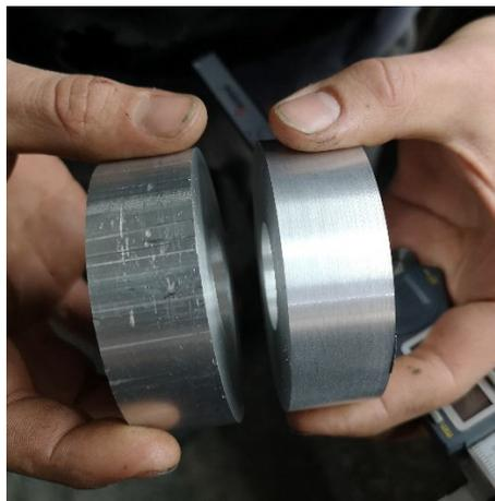
*Figura 47. Diferencia de acabado después del cilindrado. Fuente: fotografía propia*
