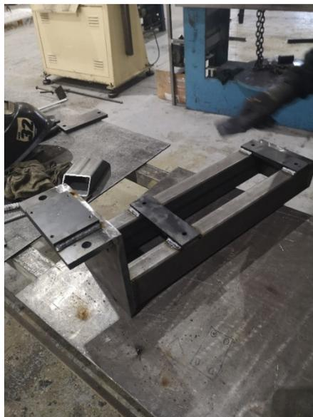
*Figura 9. Soporte del extremo del motor. Fuente: fotografía propia*
