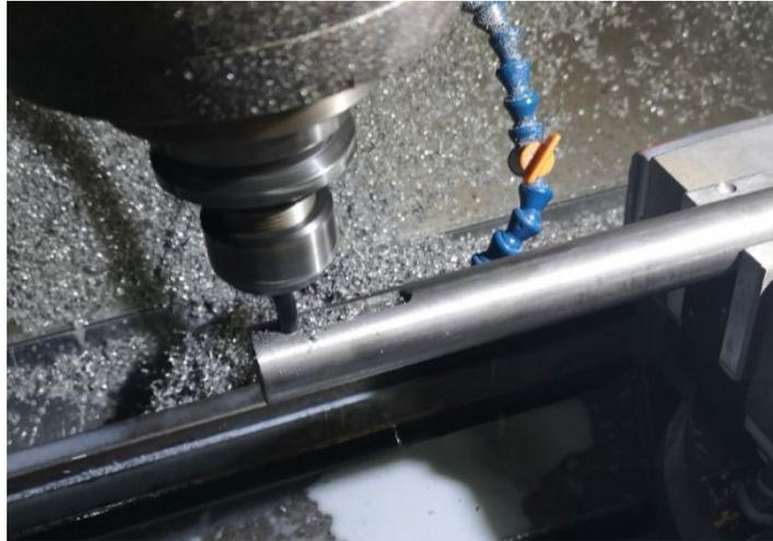
*Figura 38. Mecanizado de chaveta en eje. Fuente: fotografía propia*
