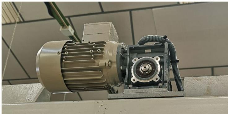
Figura 49. Motor reductor del eje portacuchillas. Fuente: fotografía propia
