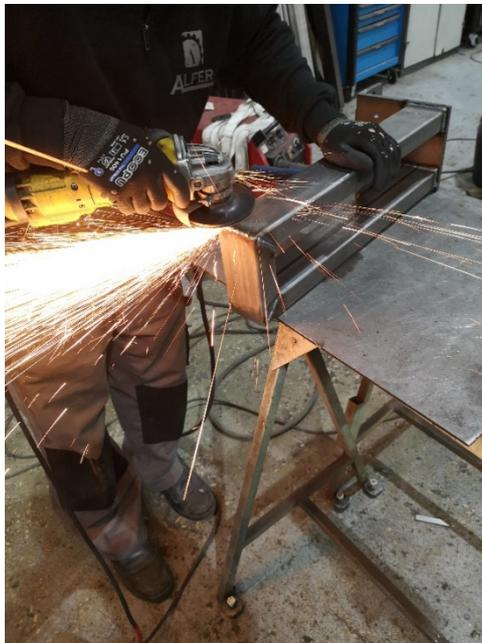
*Figura 31. Repaso de cordones de soldadura. Fuente: fotografía propia*
