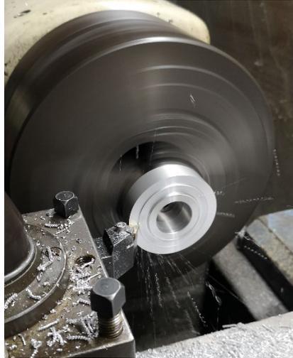
*Figura 48. Pasadas en la cara frontal para machihembrado. Fuente: fotografía propia*
