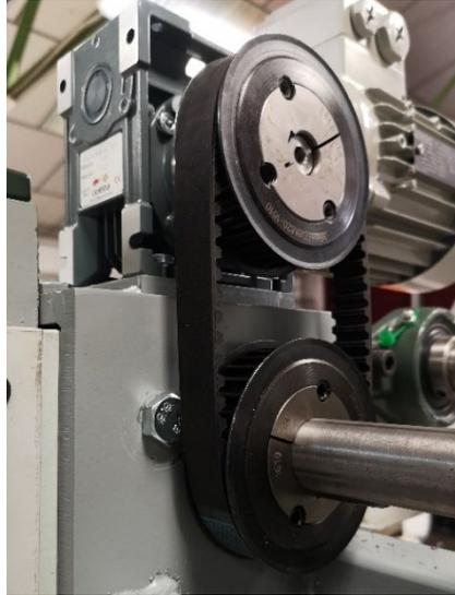
*Figura 52. Montaje del sistema de transmisión. Fuente: fotografía propia*
