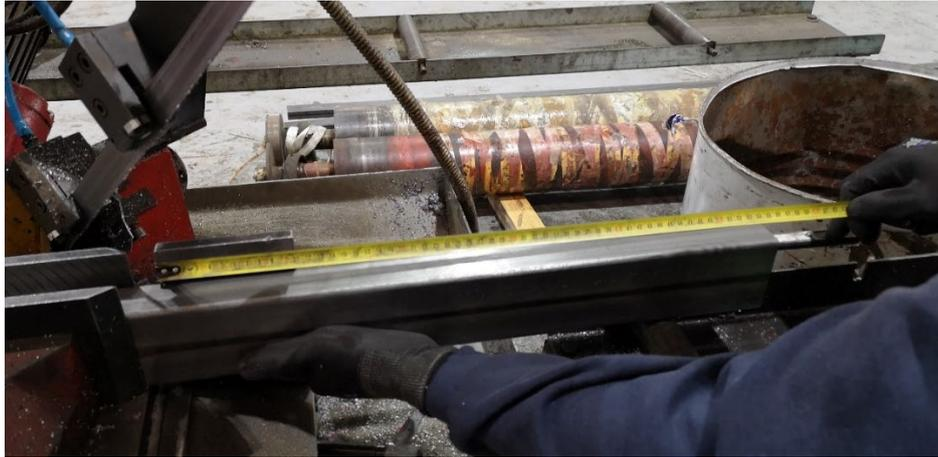
*Figura 26. Medida de tubo para corte manual. Fuente: fotografía propia*
