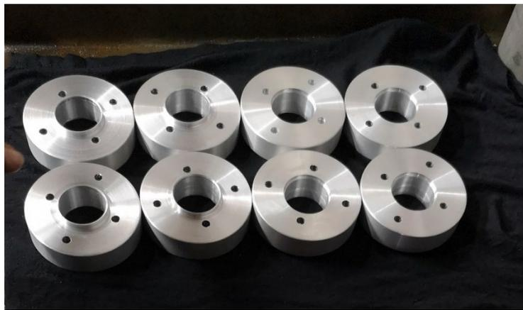
*Figura 18. Tacos separadores para cuchillas dobles. Fuente: fotografía propia*
