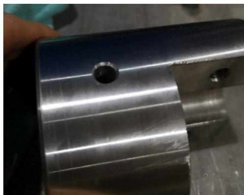
*Figura 43. Encaje de la brida finalizado. Fuente: fotografía propia*
