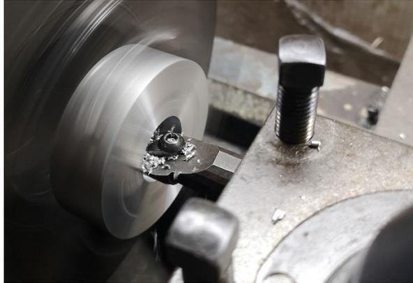
*Figura 46. Mandrilado del diámetro interior de la brida. Fuente: fotografía propia*
