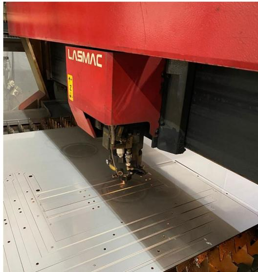
*Figura 24. Corte láser CNC. Fuente: fotografía propia*
