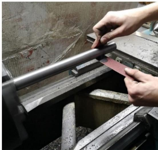
*Figura 37. Lijado de la superficie. Fuente: fotografía propia*
