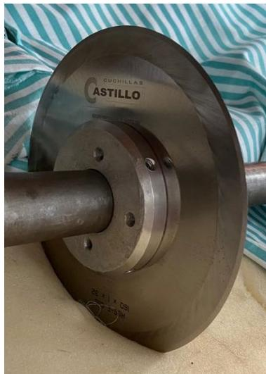
*Figura 12. Cuchilla instalada en el eje. Fuente: fotografía propia*
