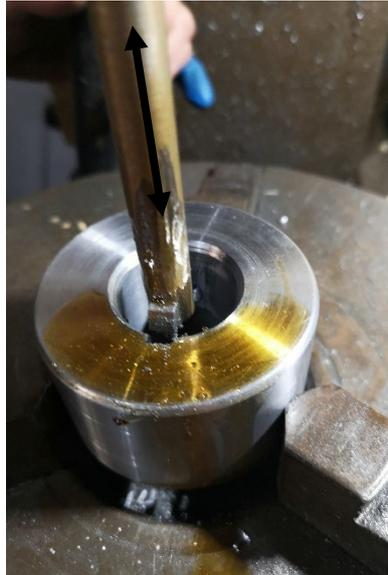
Figura 44. Sentido del movimiento de la limadora vertical. Fuente: fotografía propia
