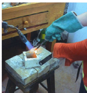
foto 25. Algunas fotos del proceso constructivo de la caja en plata, soldadura y pulido.
