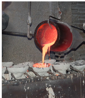
foto 17. Desde arriba, molde de cascarilla cerámica. Preparación y calentamiento de los moldes. Colada del bronce en los moldes
