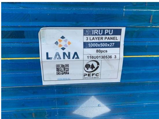
Figura 25: Tablas de encofrado con tres capas de madera pegadas. 2020. Fuente propia
