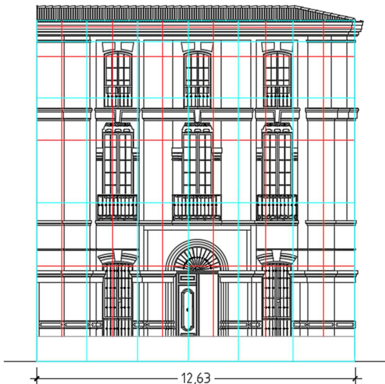
Imagen 24, Esquema de la división de los elementos metálicos y sus respectivas áreas de acción
