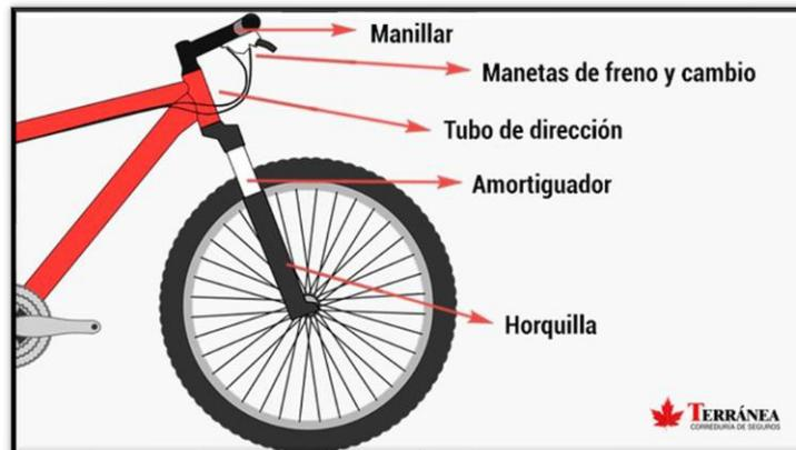
*Ilustración 2. Componentes del sistema de la dirección de una bicicleta.*
