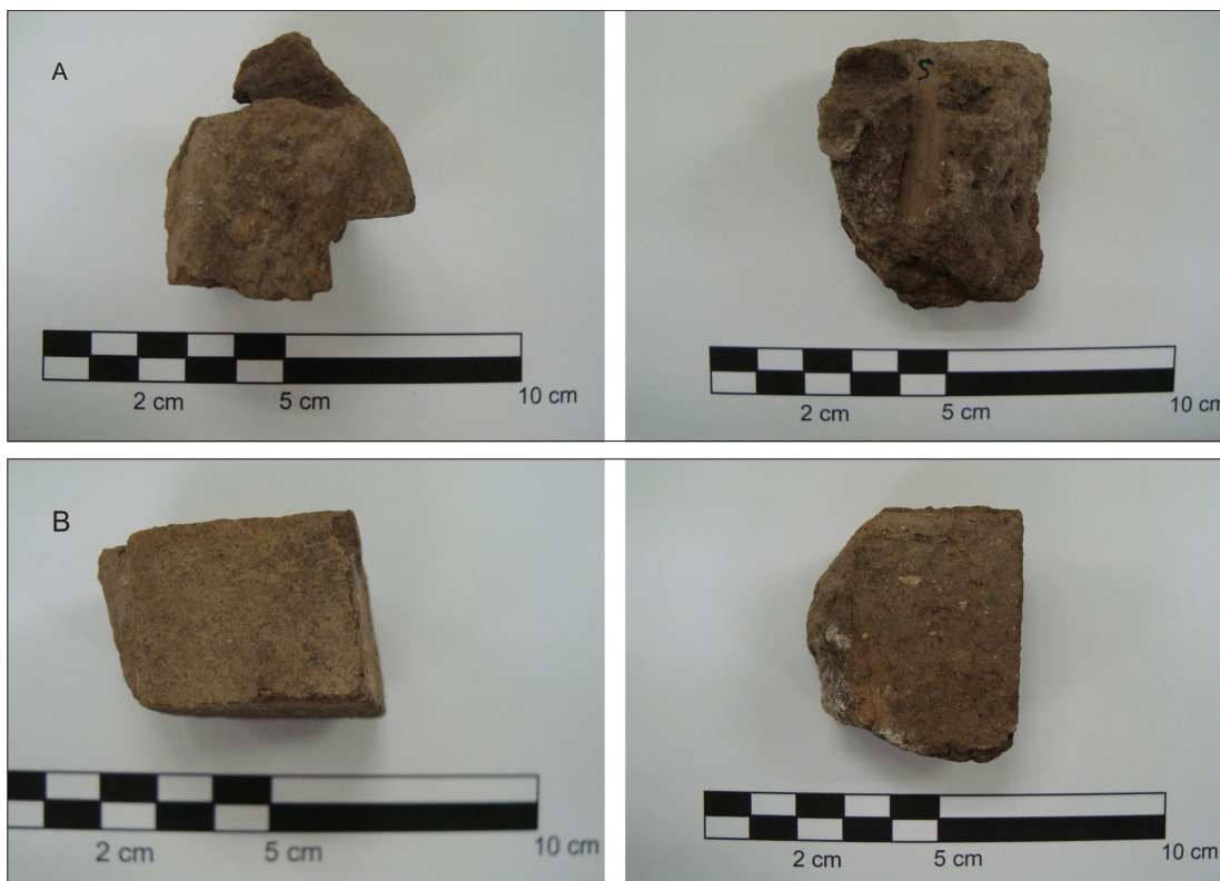
Figura 26: Aspecto tras el envejecimiento acelerado. A) Muestra M-S290, vista superior (arriba izq.) y vista perfil (arriba der.). B) Muestra M-1100, vista superior (abajo izq.) y vista perfil (abajo der.).
