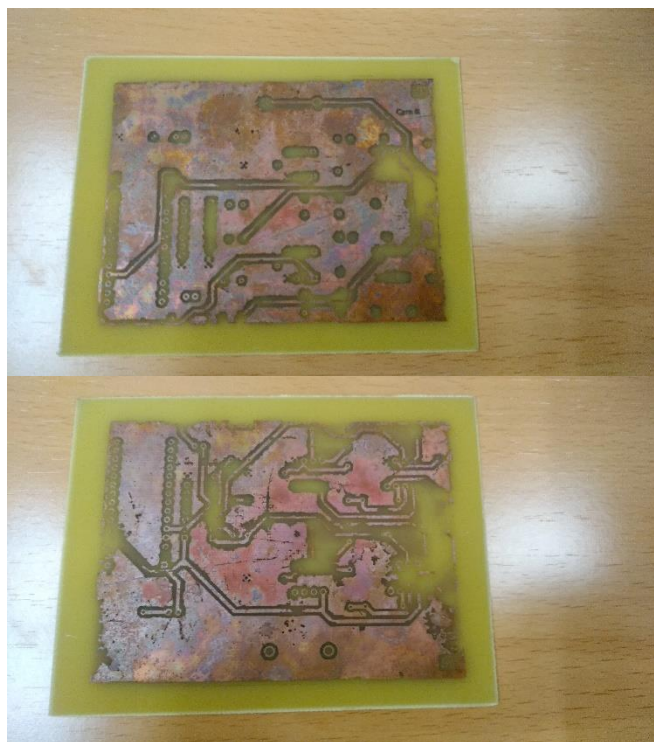
Figura 22. PCB resultant amb plaques caducades.
