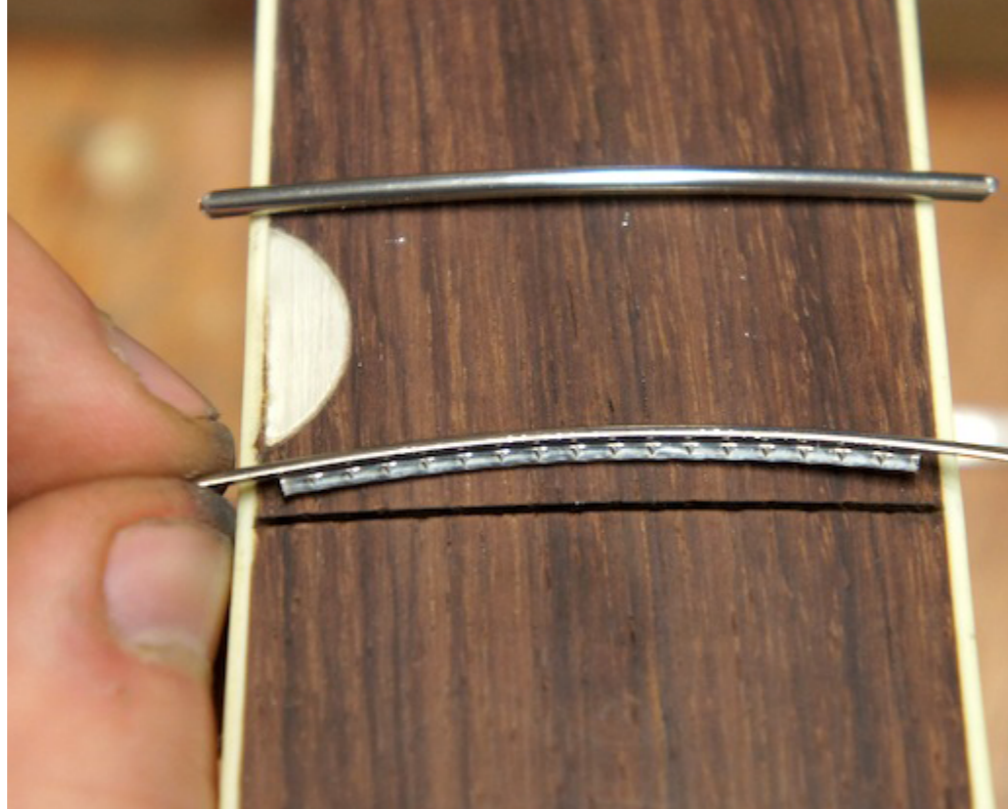
Fig.3. Traste previo a ser insertado en su ranura. El uso del "binding" en el diapasón permite recortar la espiga antes de alcanzar las caras laterales del mismo
