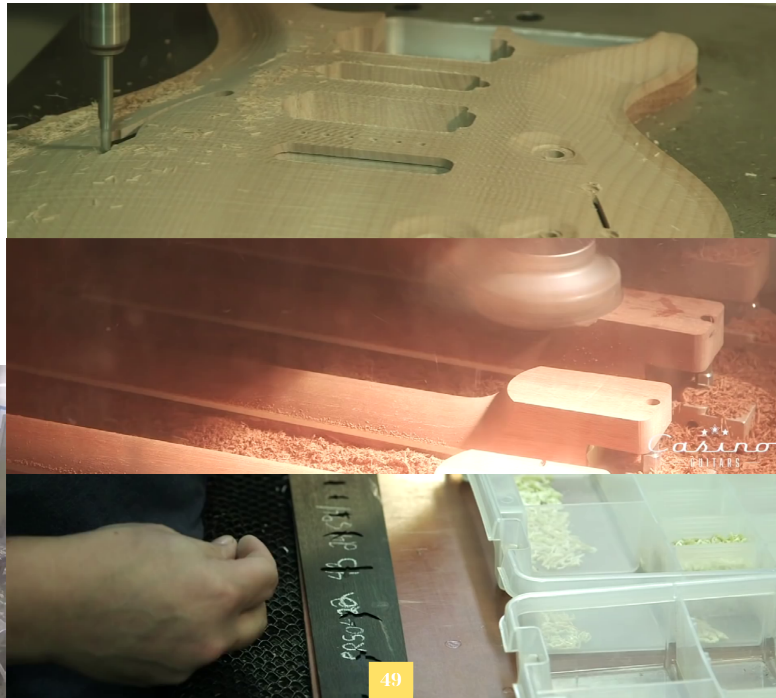
Fig.34 Cuerpo, mástiles y ranuras para las incrustaciones del diapason mecanizados por CNC en la fábrica de PRS en Indonesia
