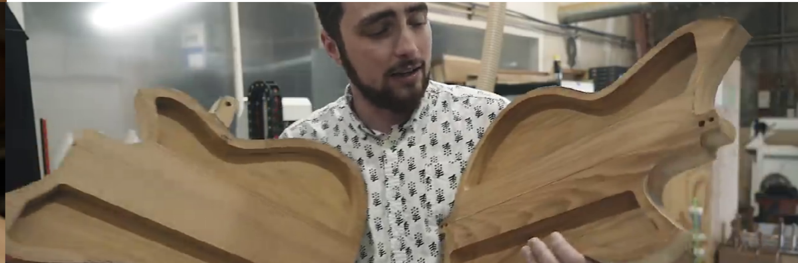
Fig.41 Imágenes del interior del taller de NOVO Guitars, donde el YouTuber Rhett Shull muestra dos cuerpos de guitarra semihuecos, de los cuales uno fue mecanizado manualmente y otro por CNC
