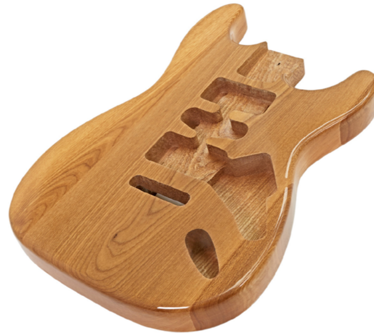
Fig.58. Cuerpo de guitarra con las cavidades para el circuito realizadas por la cara frontal, que serán cubiertas por un golpeador
