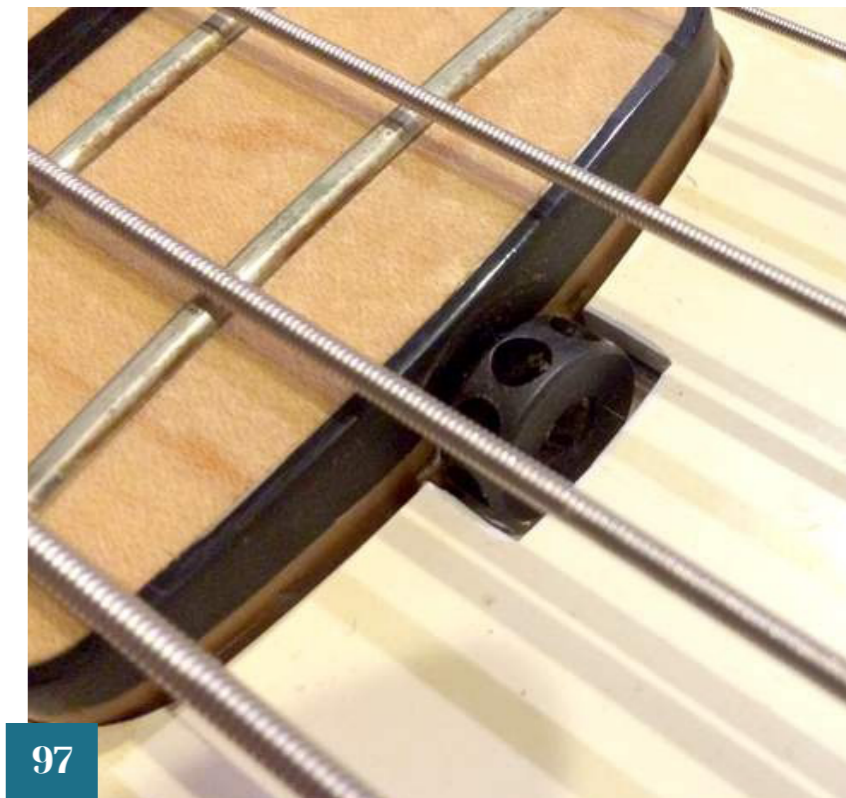
Fig.68 Guitarra con el punto de ajuste del alma en el extremo inferior del mástil.
