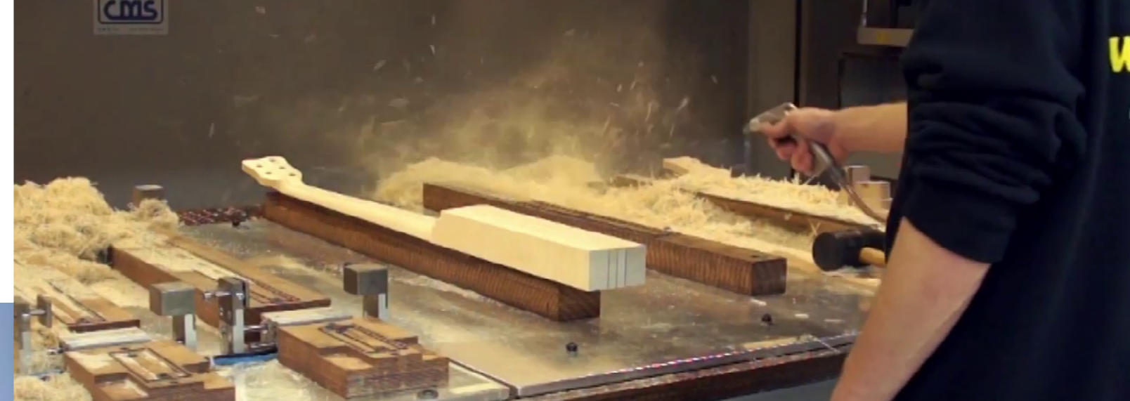
Fig.31. A la derecha, imágenes de la fábrica de Warwick en Alemania, donde el mecanizado se realiza enteramente con CNCs de 5 grados de libertad
