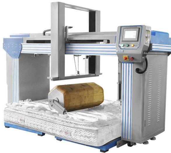
*Figura 4. Máquina de ensayo de dureza y firmeza*
