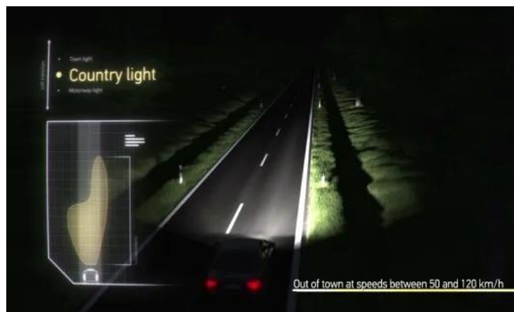
Fig. 3.12: Iluminación inteligente en carretera a más de 50 km/h
