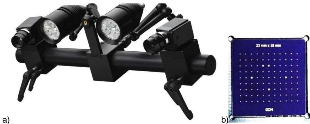
Figura 19: a) Sistema ARAMIS 4M para análisis CID 3D y b) Plantilla de calibración del sistema, ambos de la marca GOM.
