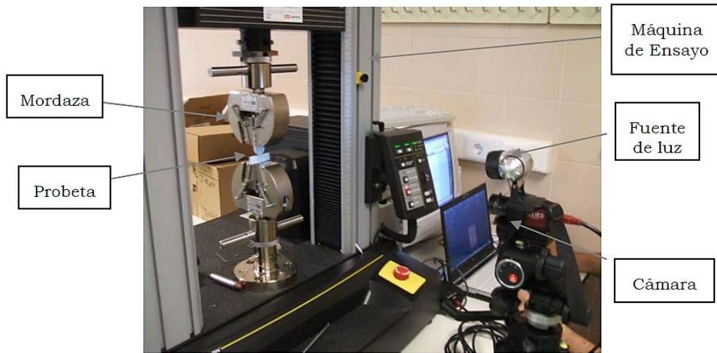
Figura 11: Configuración de equipos propuesta por López et al. (2012).
