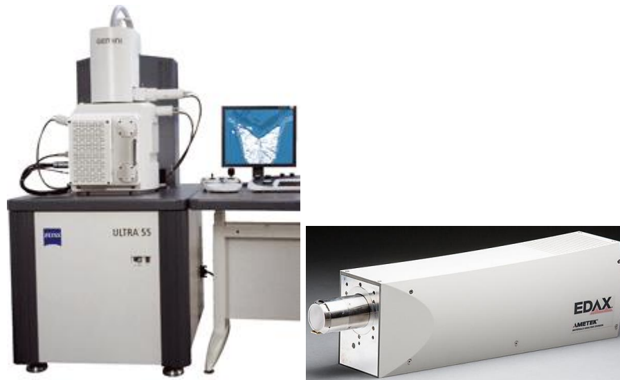
Figura 15: A la izquierda el microscopio (FEG-SEM) Zeiss ULTRA 55 y a la derecha la cámara EDAX Hikari utilizados ambos en la aplicación del método CID-HR.
