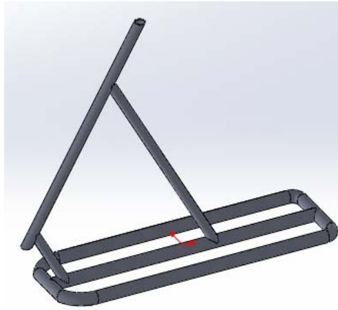
Figura 35: Diseño de ambos elementos de refuerzo con la barra de dirección.
