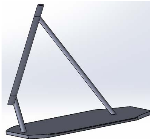
Figura 32: Unión de las barras transversales con el encamisado de dirección.
