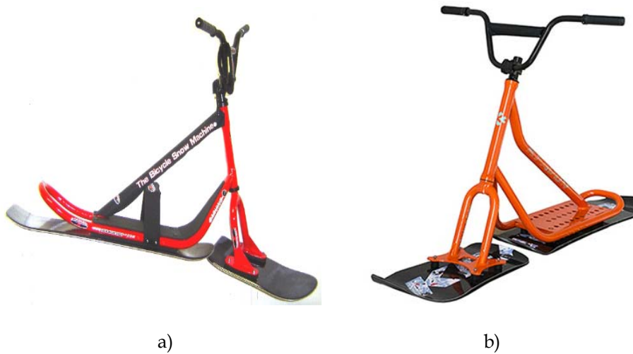
Figura 10: a) y b) Visión de la barra de refuerzo localizada en el centro del patinete.
