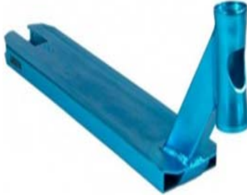
Figura 12: Chasis básico de un patinete.
