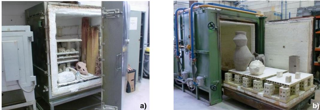
Figura 24. a) horno de alta temperatura, b) horno de baja temperatura
