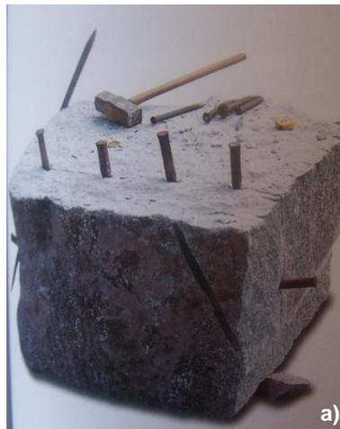
Figura 26. a) Obtención del bloque de piedra
