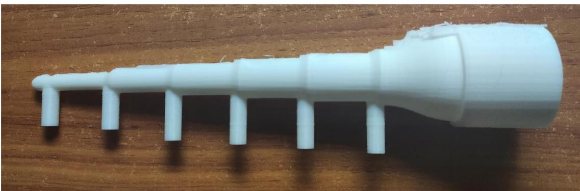
Figura 12 Modelo impreso 3D con sección variable a medida que se incorporan el resto de las distribuciones
