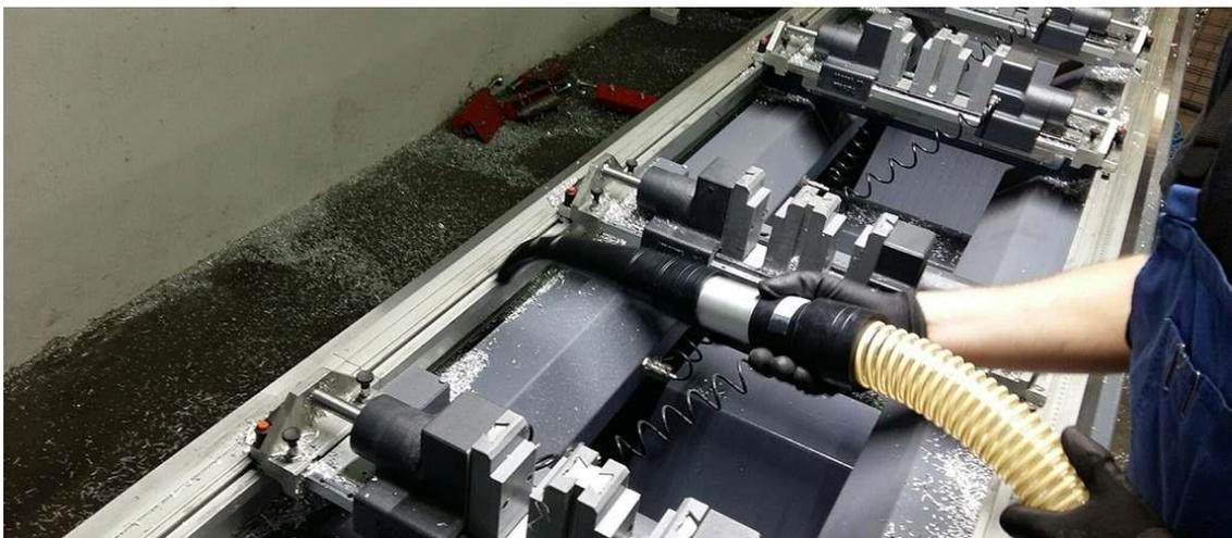
Figura 3 Ejemplo de aplicación en la industria, absorción de virutas y emulsiones (foto: delfinvacuums.com)
