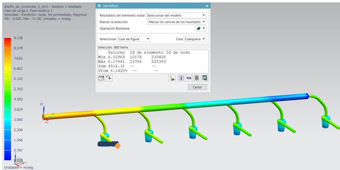
Figura 43 Captura resultado simulación, representación gráfica de velocidades en modelo 6 con la lectura de la velocidad en la entrada 1: 6,14 m/s
