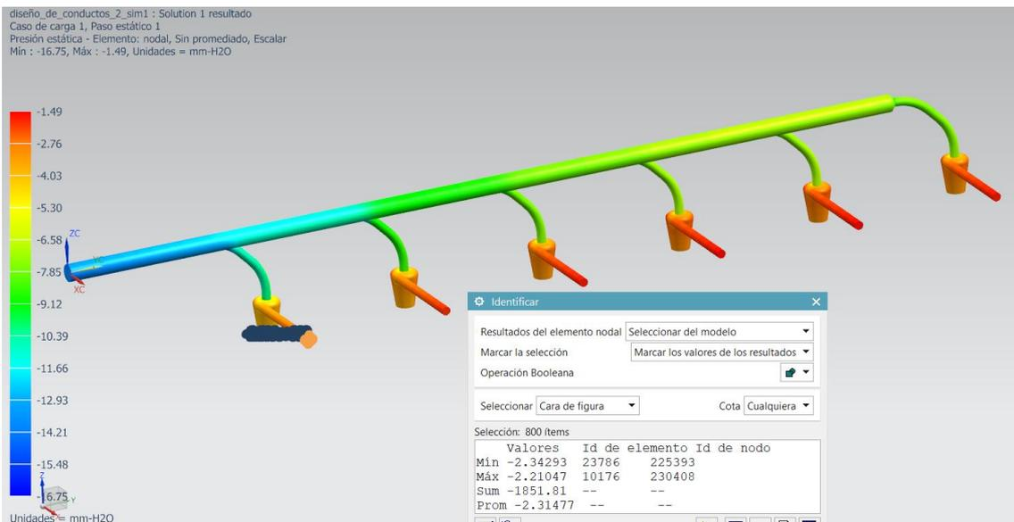
Figura 45 Captura resultado simulación, representación gráfica de presión estática en modelo 6 con la lectura de la presión en la entrada 1: -2,31 mmH<sub>2</sub>O
