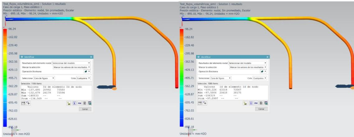
Figura 21 Captura resultado simulación: Presión de vacío entrada 1: -134.57 mmH<sub>2</sub>O; Presión de vacío entrada 2: -97,9 mmH<sub>2</sub>O
