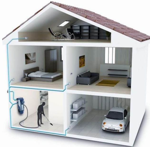
Figura 2 Sistema central de aspirado para el hogar (foto: inkodu.ee)
