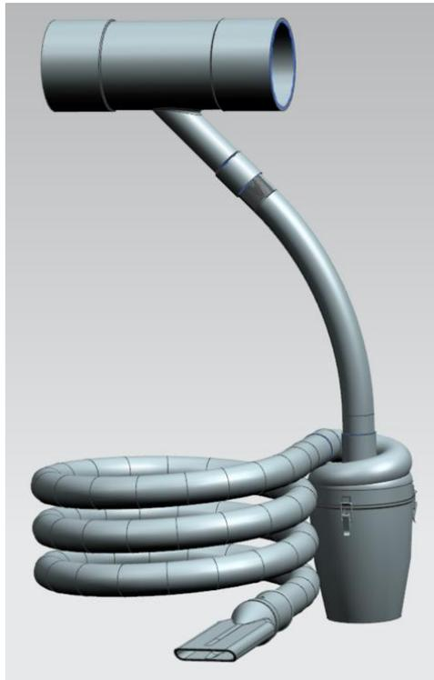
Figura 60 Ensamblaje conducto secundario con unión al conducto general.
