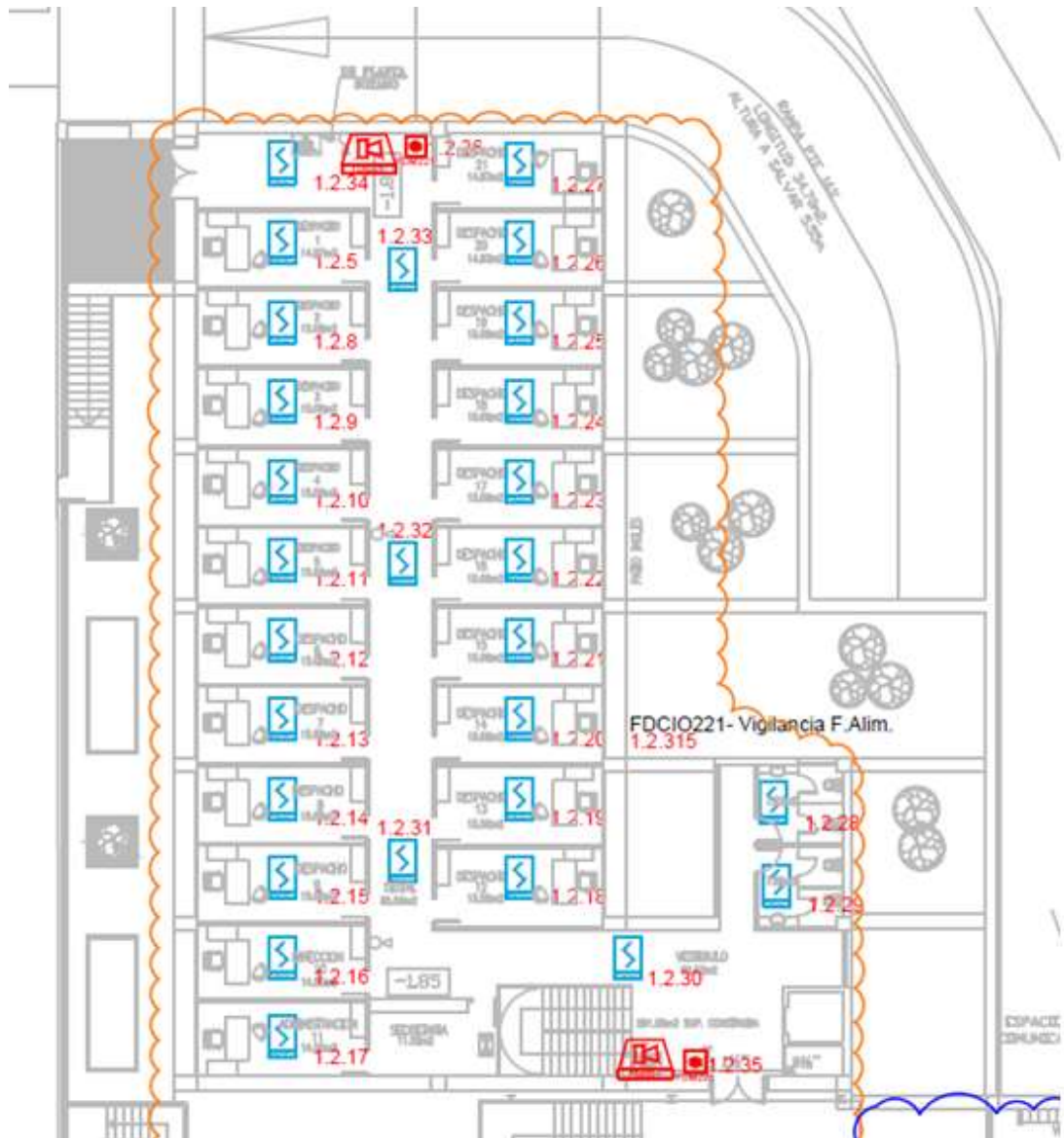
Ilustración 19: Sistema de detección de incendios en semisótano
