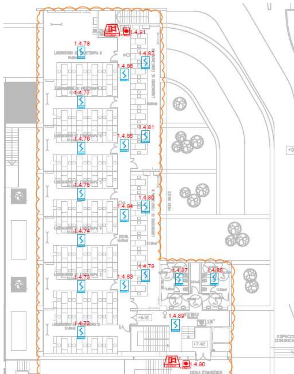
Ilustración 21: Sistema de detección de incendios en planta primera
