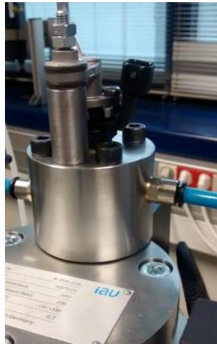
Figura 2.23: Inyector, soporte del inyector y medidor de tasa IAV utilizado en el montaje experimental. [18]
