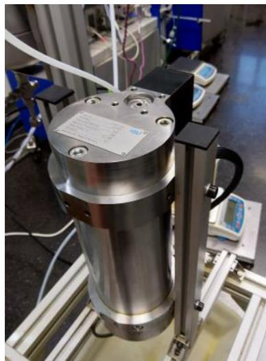
Figura 2.21: Tasímetro en laboratorio del CMT. [28]
