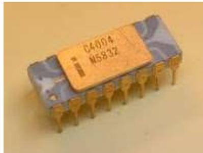
Ilustración 4: Primer microprocesador de Intel, el Intel 4004 (1971)
