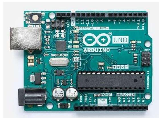
Ilustración 7: Placa Arduino UNO
