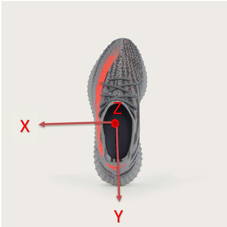
Ilustración 36: Disposición de los ejes de referencia del acelerómetro respecto al calzado
