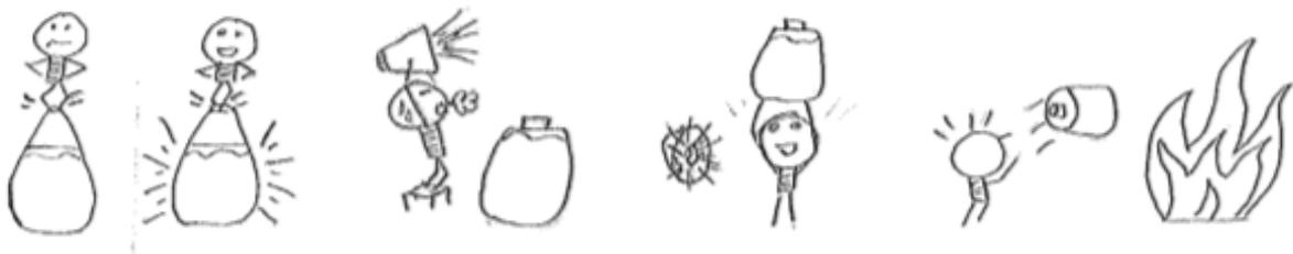
Figura 9 . Boceto que representa la secuencia de uso de la luminaria extintora.
