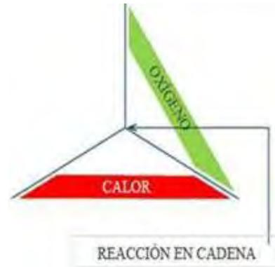
Figura 4. Triángulo del fuego en el que se elimina el componente combustible. Fuente: <https://www.pinterest.es/pin/749990144165289422/>
