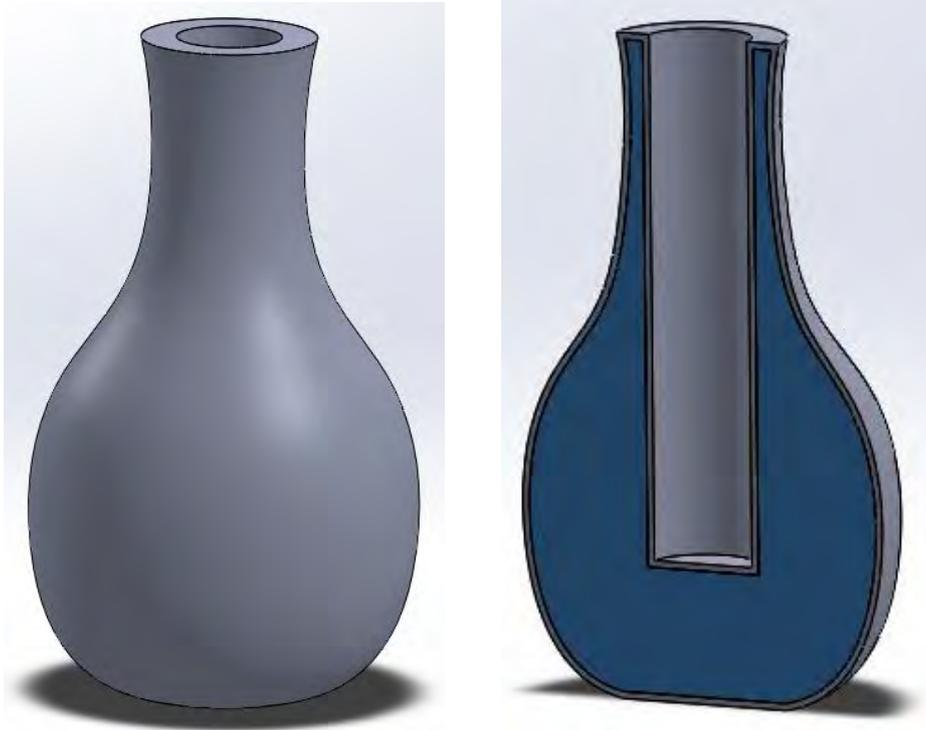
Figura 55. Modelo 3D del florero estilo orgánico con corte para visualizar el volumen interior
