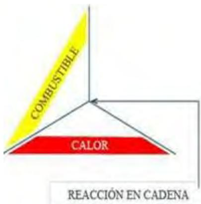
Figura 5. Triángulo del fuego en el que se elimina el componente oxígeno. Fuente: <https://www.pinterest.es/pin/749990144165289422/>
