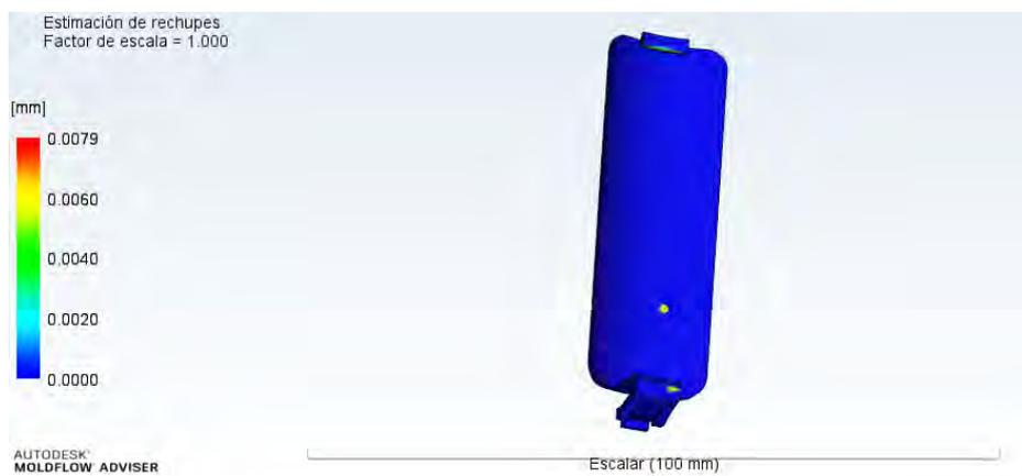
Figura 122. Estimación de rechupes de la pieza 1.3. – tapa de las pilas estilo orgánico
