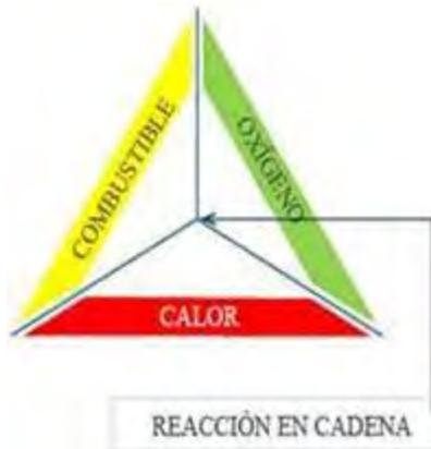
**Inhibición catalítica:** a nivel atómico, el fuego se propaga por medio de los radicales libres generados y expulsados de la reacción química de la combustión, como el hidrógeno o el carbono libres, cuyos productos son muy reactivos. El uso de extintores de polvo químico seco y los hidrocarburos sobre las llamas detienen esta reacción, ya que separan físicamente estos radicales.
