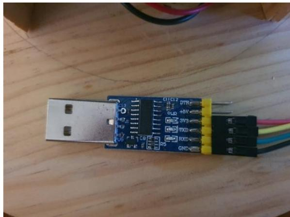
Fig. 12: Adaptador para conexión por puerto serie. Fuente propia.
