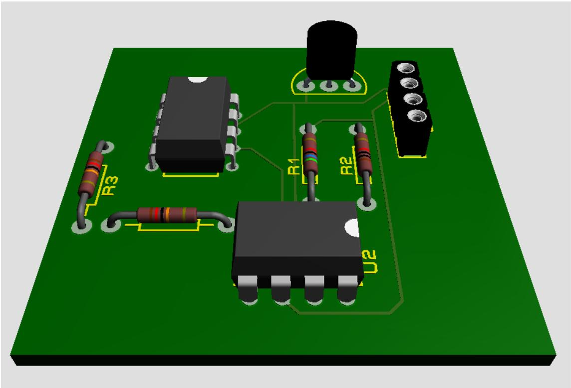
El circuito más próximo al microcontrolador se trata de un divisor de tensión que ajustaremos para que transforme una tensión de 9,9V a 3,3V, ajustándose debidamente también a la caída de tensión que realizamos midiendo la señal que tenemos y con la ayuda de otro sensor de temperatura.
