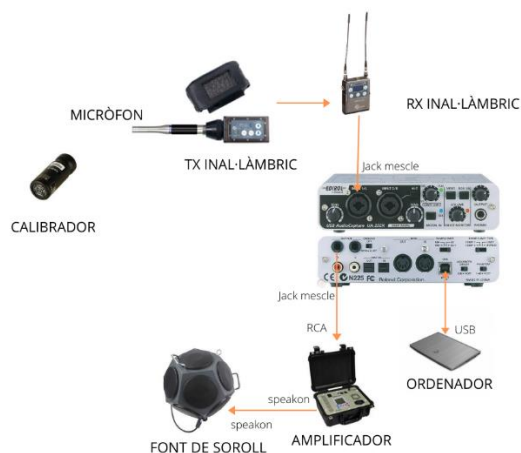
Il·lustració 19 : Esquema de connexió per a mesurar la resposta al impuls
