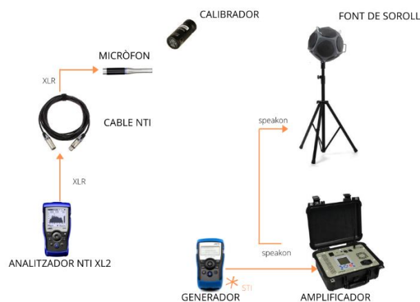
Il·lustració 18 : Esquema de connexió de sonòmetre
